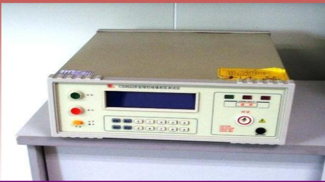
B. 耐电压绝缘测试仪
