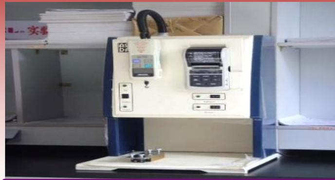
C. 铜箔拉力测试仪
